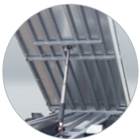
Robuuste vloerondersteuning door kokerprofielen
