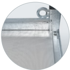
Aluminium laadvloer en bindogen in de hoeken
